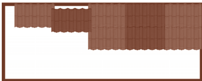
Doporučený postup montáže krytiny od hřebene
