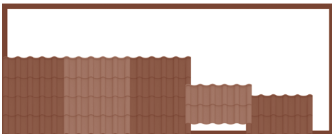
Doporučený postup pokládky od okapové hrany zleva
