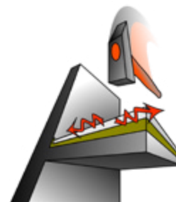
Šíření hluku konstrukcí bez kročejové izolace a s kročejovou izolací
