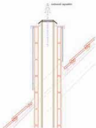
Řez hlavou s komínovým návlekiem
