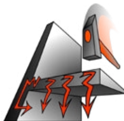
Šíření hluku konstrukcí bez kročejové izolace a s kročejovou izolací
