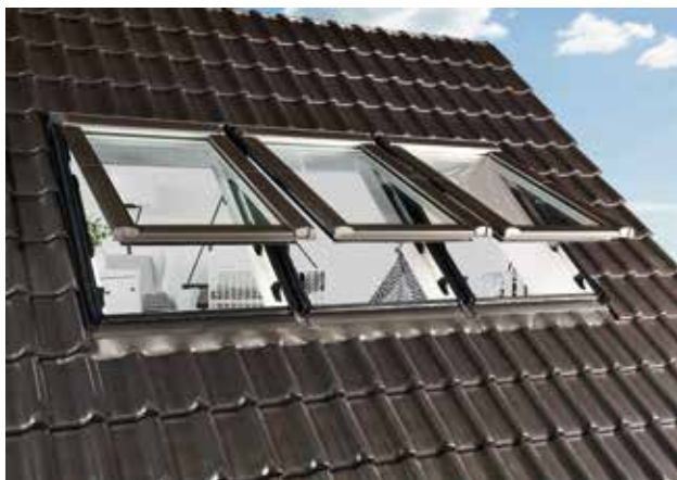
Kombi-lemování 3x1 s pomocnou krokví EKS a roztečí ráků 120 mm
