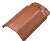
hřebenáč F9 Stylis (spotřeba 3ks/bm, pro sklon do 40°)
