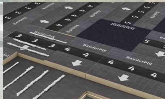
obr. příklad pokládky BauderPIR GFS výplň rozvodí
